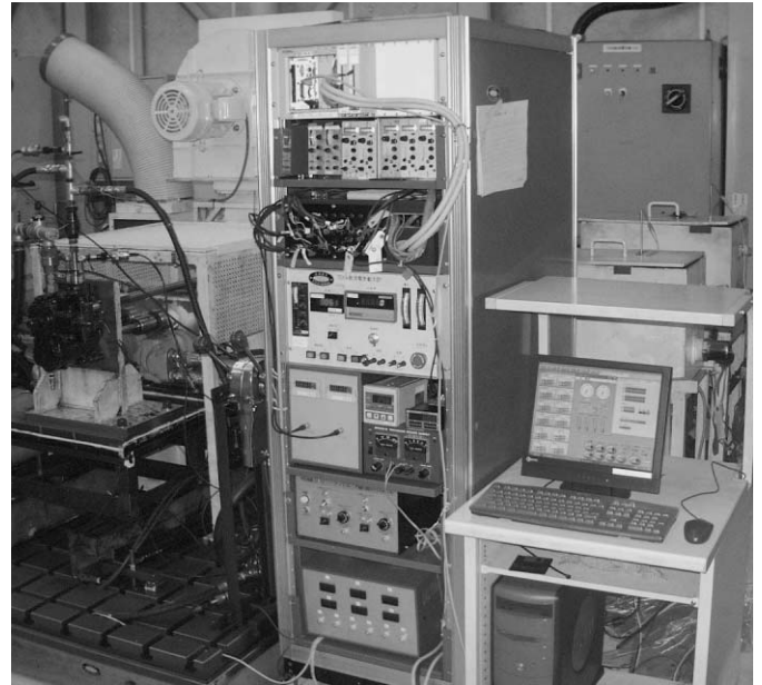
油圧無断変速機試験装置 テストベンチ
